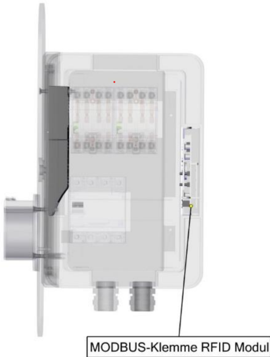
Abbildung 3. Anschluss der Modbusleitung
